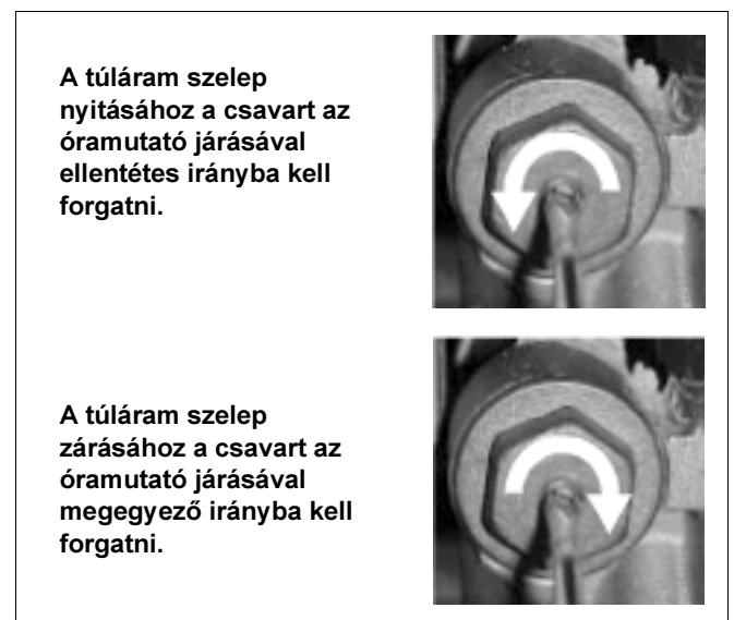
30. ábra A túláram szelep beállítása
